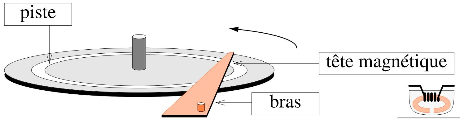
Périphérique de mémoire « à long terme », par enregistrement magnétique sur un support métallique recouvert d'une couche magnétisable.
